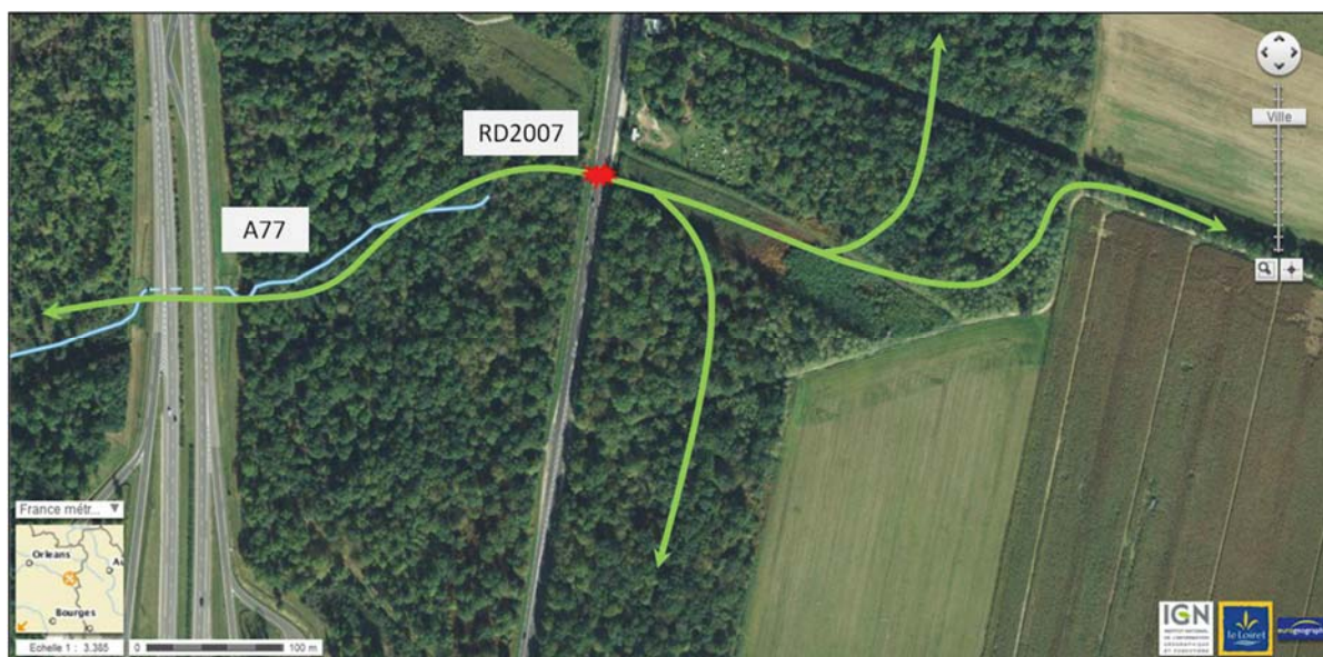
Maintien du corridor fonctionnel entre la haie arborée et les boisements périphériques avec passage à faune au niveau de l'A77
